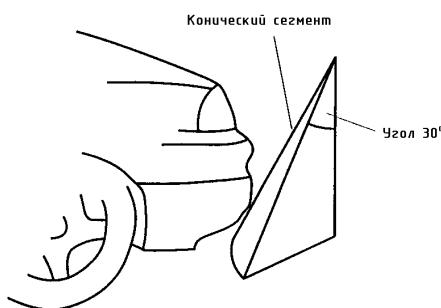
Рисунок 3.1. Определение линии пола
