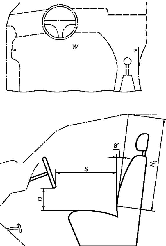
Рисунок 1.6.1. Размеры, которые должны быть выдержаны в кабине
