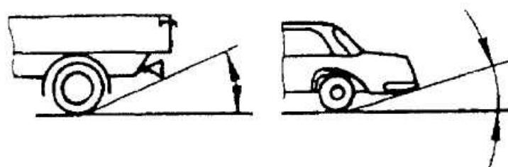
Рисунок 2. Угол съезда
